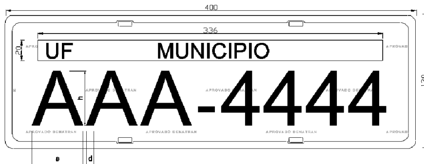
Figura 1 - Dimensões de uma placa de veículo
