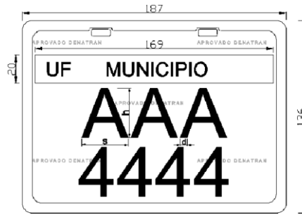
Figura 2 - Dimensões de uma placa de motocicleta
