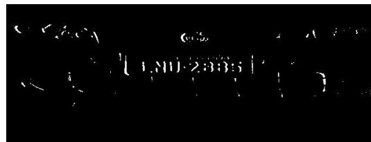
Figura 7 - Binarização da imagem após a aplicação do filtro Sobel vertical
